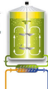
Die hoeba Fermenter-technik ermöglicht die reibungslose Wartung aller Anlagenkomponenten auch im laufenden Betrieb, da Rührwerk und Wärmetauscher extern zugänglich sind.
