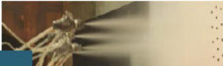
Die Platten werden beidseitig mit einer Keramikbeschichtung in den Stärken von 180 - 360 µm beschichtet.
